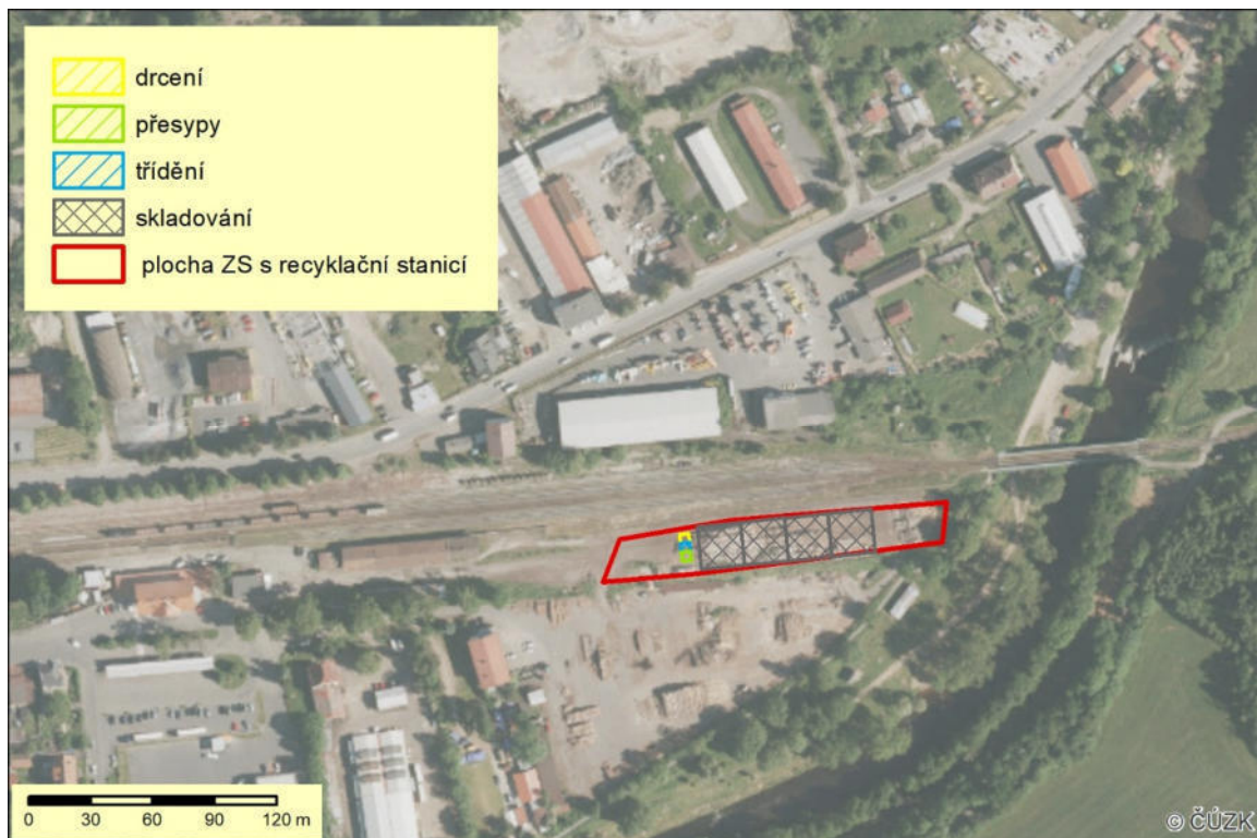
Obr. 4: Schematický zakres rozdělení a umístění plošných zdrojů znečištění
